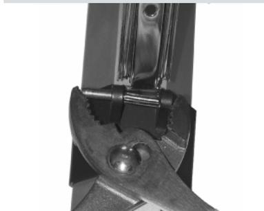
Fig. 7: Instale el perno a la abrazadera de pata del (Estilo 2).
