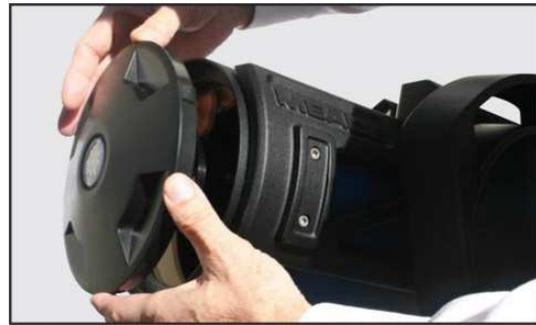
10 Ahora retire la tapa frontal del tubo óptico del Telescopio. Cuide de no tocar el plato corrector de cristal del telescopio.
