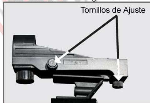
Ahora, sin mover el telescopio, ajuste los tornillos que se indican en la imagen de arriba hasta que coloque el punto rojo sobre el objeto que está observando. Es así de simple.
