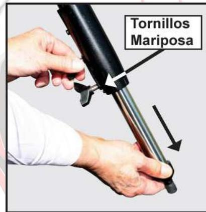
**3** Enrosque los dos tornillos mariposa de cada pata (seis en total) cerca de final de cada pata. Use estos tornillos para variar la extensión de las patas, y por ende del tripié. Apriete los tornillos con la mano; no apriete demasiado.
