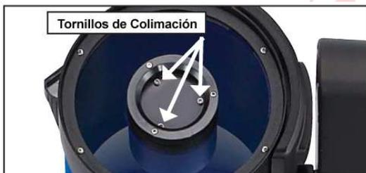
Figura 14: Colimación del telescopio LT
