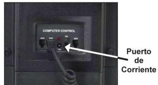
**7** Utilice solamente el Adaptador Universal AC Meade (parte 07584 para 110Vca ó 07584F para 220Vca) con su telescopio LT cuando lo conecte a corriente alterna. Esta diseñado específicamente para proveer el voltaje de calidad y para proteger la electrónica de su telescopio. Otros adaptadores de corriente pueden anular la garantía de su telescopio.
