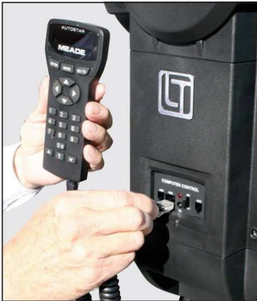
8 Asegúrese que el interruptor general esté apagado. Saque el controlador y su cable del empaque. Conecte un extremo del cable en el puerto HBX del panel de control y el otro extremo al controlador #497.
