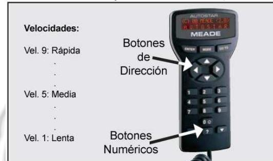
12 Verá "Press 0 to align or Mode for Menu". Puede utilizar los botones de dirección para mover el telescopio. Para cambiar la velocidad, presione un botón numérico. "9" es la más rápida y "1" es la más lenta. Vea la página 20 para más detalles. O puede presionar el "0" para iniciar la Alineación Fácil (Easy Alignment). Vea la pág. 11 para más info.
