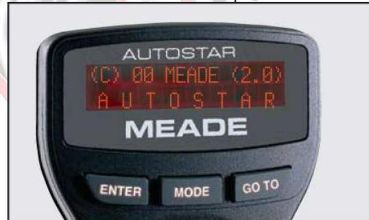
11 Encienda el interruptor general en el panel de control. Verá en la pantalla LCD del AutoStar un mensaje de derechos de autor.
