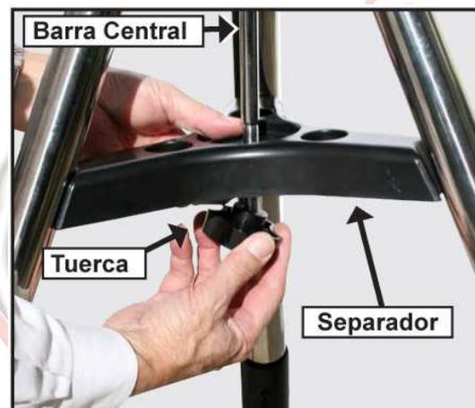
**4** Quite la tuerca de la barra central e inserte el separador entre las patas del tripié. Coloque la tuerca y apriétela con la mano hasta que las patas se separen y aprieten contra el separador. Coloque el tripié donde lo vaya a utilizar y revise que la parte superior esté nivelada.
