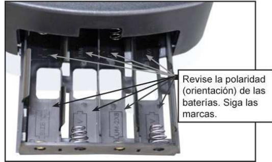
**CAUIDADO:** Tenga cuidado de instalar las baterías como se indica en la charola. Siga las recomendaciones del fabricante de las baterías. No instale las baterías al revés ni mezcle nuevas con usadas. No mezcle distintos tipos de baterías. Si no sigue estas precauciones, las baterías podrían explotar, encenderse o chorrearse. La instalación inadecuada de las baterías anularán la su garantía Meade. Siempre quite las baterías si su telescopio no va a ser utilizado por un periodo prolongado.
