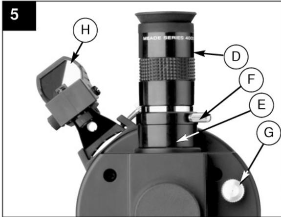
5. **Inserte el ocular:** Vista trasera de los modelos con buscador de punto rojo (H). Saque el ocular de 26 mm (D) de su estuche plástico y colóquelo en el porta-ocular (E). Apriete los tornillos de aseguramiento (F) sin apretar demasiado. Quite el cubre-polvos del final del tubo óptico. Gire la perilla de enfoque (G) para enfocar los objetos que observa.
