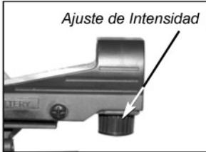
Fig. 13: Para modificar la intensidad del brillo gire el control de intensidad.
