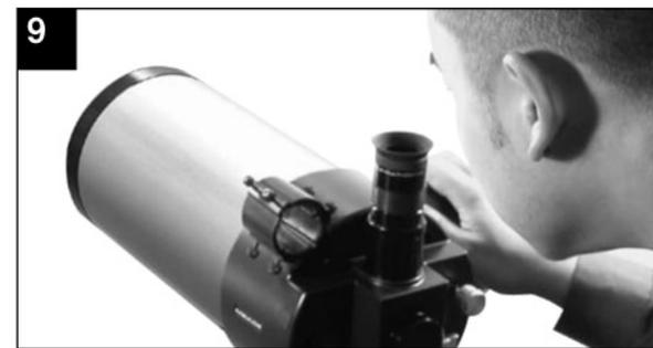
9. **Vea por sobre el tubo de su telescopio:** Vea por sobre el tubo de su telescopio para localizar un objeto. Practique utilizando los botones de dirección del Autostar para centrar un objeto en el campo de visión del telescopio.
