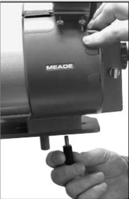
Fig. 7: Asegure el tubo óptico al plato de montaje utilizando los tornillos de aseguramiento.
