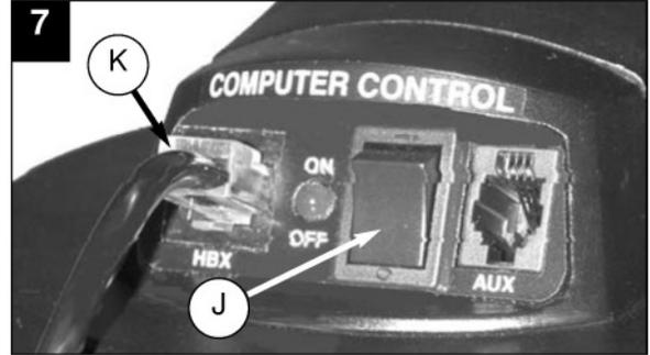
7. **Conecte el Autostar:** Asegúrese que el interruptor de encendido (J) en el panel de control esté apagado (en la posición OFF). Conecte el Controlador Autostar en el puerto HBX (K). Encienda el panel; el LED se enciende cuando el panel del telescopio tiene corriente.
