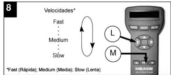
8. **Cambie de velocidades:** Ahora puede utilizar los botones de "dirección" (L) para mover el telescopio hacia arriba, abajo, derecha o izquierda. Para seleccionar una de las nueve velocidades de su telescopio, pulse brevemente el botón SPEED/? (M). Cada pulso decrece la velocidad un nivel, y entonces vuelve a la primera y más alta de manera cíclica.
