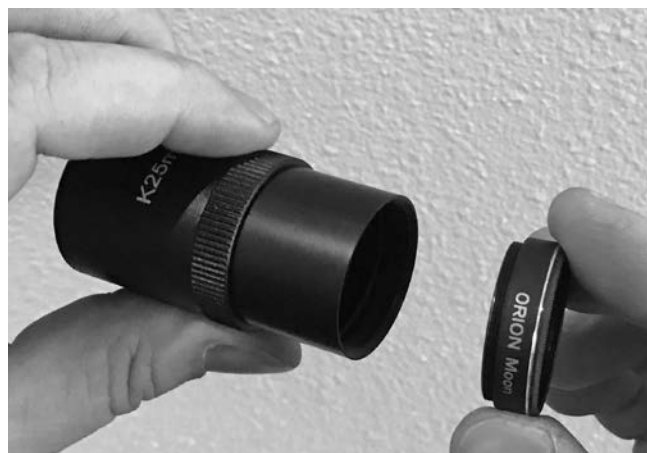
Figura 14. Los oculares Kellner tienen cilindros roscados que admiten filtros opcionales de 31,75 mm de Orion. Un filtro lunar es útil para reducir el resplandor y ver más detalles de la superficie lunar.
