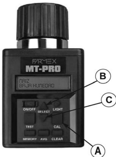
*NOTA: La calibración de grano no puede ser realizado a menos que se haya realizado una prueba valida de humedad.*
