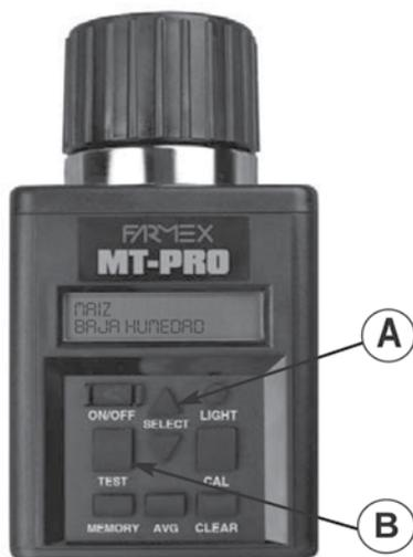
**NOTA:** Para usar otras funciones incluidas en el medidor empuje SELECT botón (A) arriba o abajo para conseguir la función deseada, empuje botón (B) para realizar la función.
