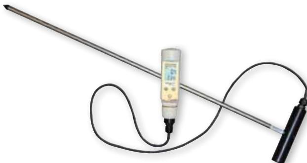
Medidor FieldScout de Contacto para suelo con asa en forma de T
