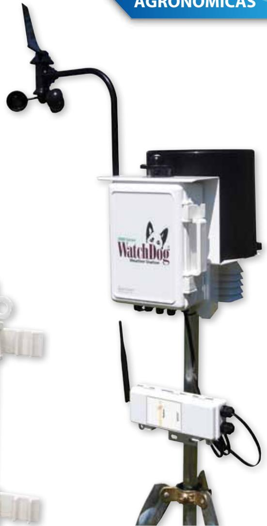
*Módem DataScout montado con una estación meteorológica WatchDog 2000 Serie Full*
