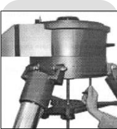
Fig. 48: Coloque la base de A.R. al trípode.
