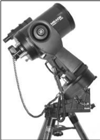
Fig. 40: LX200GPS montado sobre una montura (wedge) ecuatorial.
