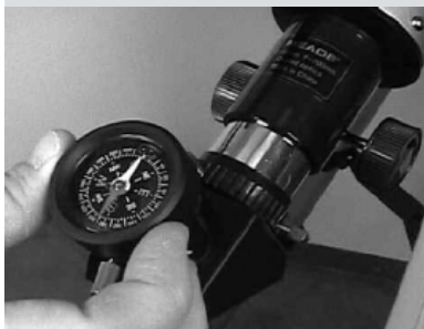
Fig. 12: Quite el ocular y coloque la brújula y nivel de burbuja en el barril donde se coloca el ocular.
