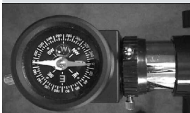
Fig. 13: Mueva el tubo óptico hasta que el tubo apunte al Norte en la brújula.
