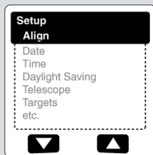
Fig. 20: La opción del menú se muestra en el segundo renglón. Use las flechas de desplazamiento para moverse hacia arriba o abajo en la lista de opciones. Presione ENTER para seleccionar la opción deseada.
