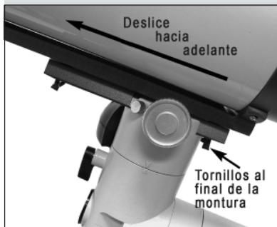
Fig. 55: Ajuste del balance del tubo óptico cuando se utilizan accesorios pesados.
