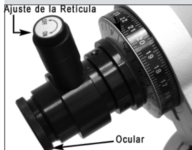
Fig. 43: Buscador para alineación polar.
