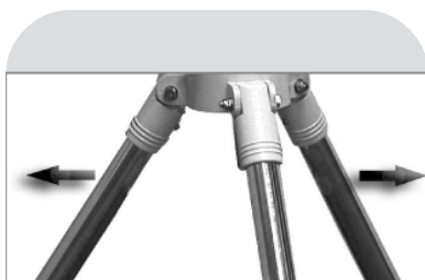
Fig. 3: Abra las patas del trípode.
