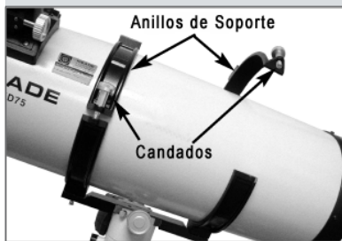
Fig. 8: Cloque el tubo óptico en los anillos y atornille sin apretar los tornillos de seguridad.
