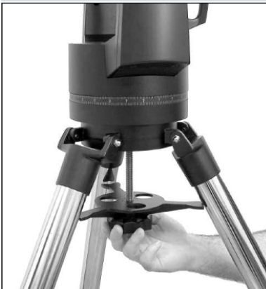
Fig. 4: Cómo fijar el telescopio al Trípode. Asegúrese de orientar la Charola/Separador con el lado plano hacia arriba.
