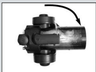
Fig. 29b (vista superior): ...luego gírelo a favor de las manecillas del reloj un cuarto de vuelta...
