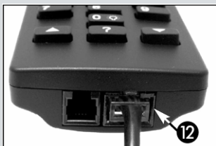
Fig. 14: Puerto HBX del Autostar.
