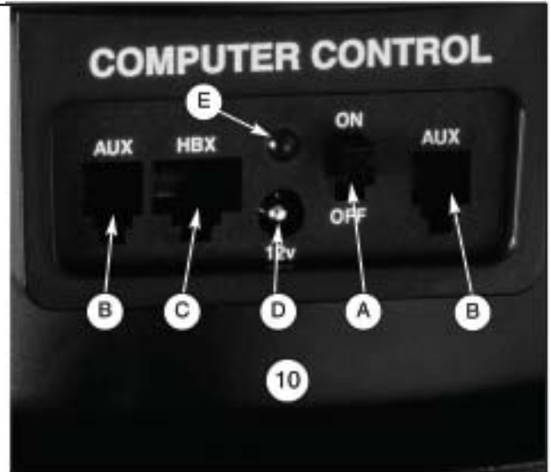
Fig. 2 (recuadro): Panel de Control. (A) interruptor general; (B); puertos auxiliares; (C)puerto de controlador (HBX); (D) conector 12 V cc; (E) LED - luz indicadora de corriente.
