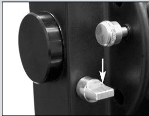
Fig. 31b: Leva de control del espejo en la posición "horizontal".
