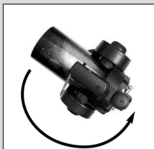
Fig. 29a (vista superior): Gire el telescopio en contra de las manecillas del reloj hasta que tope...
