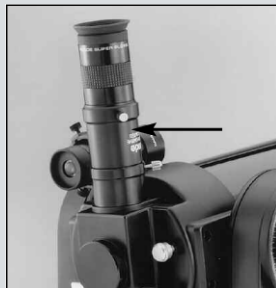
Fig. 36: Utilice el lente Barlow #126 para duplicar la magnificación del ocular utilizado.
