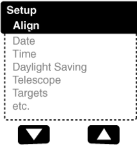
Fig. 27b: La opción del menú se muestra en el segundo renglón. Use las flechas de avance para moverse hacia arriba o abajo en la lista de opciones. Presione <ENTER> para seleccionar la opción deseada.
