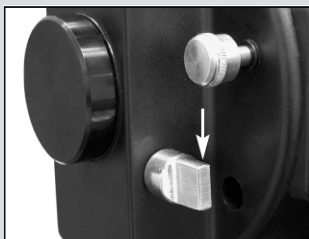
Fig. 3a: Control del espejo abatible en la posición "vertical".
