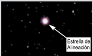
Fig. 25: Durante la alineación, la estrella de alineación siempre será la más brillante en el sector del cielo hacia donde apunta el telescopio.
