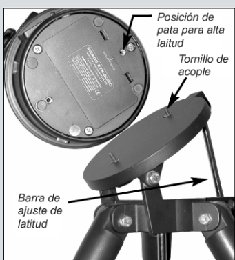
Fig. 45: Orificio para la pata para altas latitudes y su correspondiente tornillo de aseguramiento.
