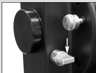
Fig. 3b: Control del espejo abatible en la posición "abajo".
