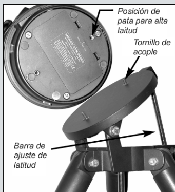
Fig. 44: Orificio para la pata para altas latitudes y su correspondiente tornillo de aseguramiento.
