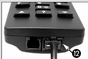
Fig. 14: Puerto HBX del Autostar.
