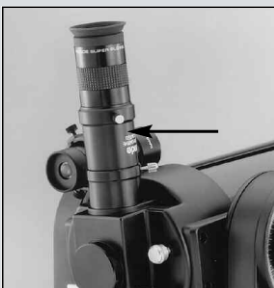
Fig. 35: Utilice el lente Barlow #126 para duplicar la magnificación del ocular utilizado.
