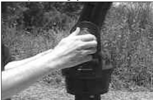
Paso 7: Afloje el candado vertical para mover el tubo óptico.
