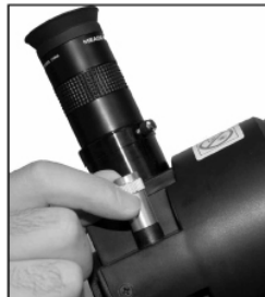
Fig. 10: Inserte el ocular y enfoque.
