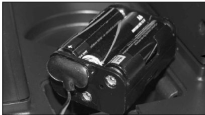
Fig. 1c: Compartimiento de baterías.
