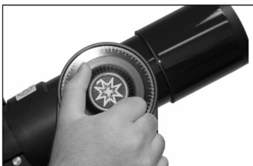
Paso 2: Afloje el candado vertical para mover el tubo óptico.
