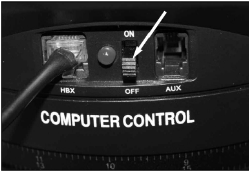
Paso 8: Conecte el controlador en el puerto HBX del panel de control.
