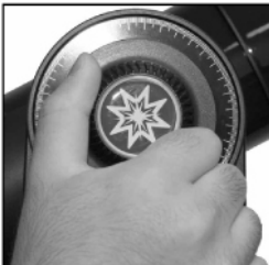
Fig. 7: Afloje el candado vertical y mueva el telescopio hacia abajo.
