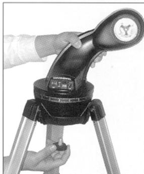
**Fig. 5:** Montaje e la montura al trípode.
