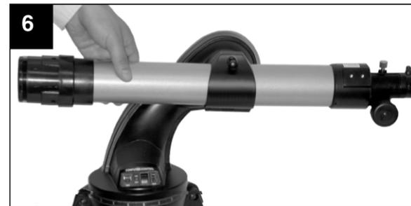
6. **Coloque y balancee el tubo óptico:** Coloque el tubo óptico en el anillo de soporte. Apriete el tornillo de aseguramiento del arnés para sostener el tubo pero permita que se pueda deslizar. Deslice el tubo hacia delante y atrás hasta que encuentre la posición donde el tubo permanezca horizontal (sin que se incline hacia algún lado por sí solo). Apriete el tornillo de aseguramiento firmemente.
