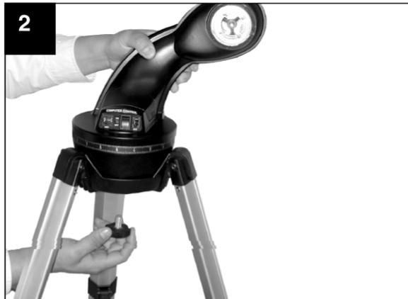
2. **Coloque la montura:** Coloque la montura sobre el cabezal del tripié. Alcance, por debajo del cabezal, la perilla de aseguramiento de la montura y atorníllela en la base de la montura. No apriete demasiado. Eventualmente, podrá necesitar aflojarla y girar la montura con el telescopio (vea el paso #6).
