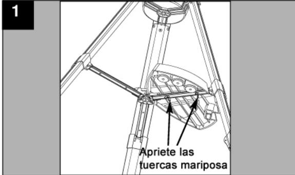
1. **Abra el tripié:** Saque el tripié de la caja y párelo verticalmente sobre el suelo. Suavemente jale las patas abriéndolas hasta que las tres lleguen a su apertura máxima. Coloque la charola al tripié: Deslice los tornillos por los orificios en la charola y coloque las tuercas mariposa como marca el dibujo.
