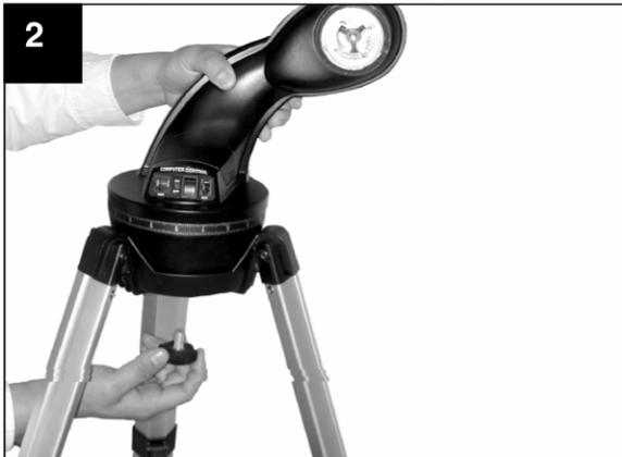
2. **Colocando la montura:** Coloque la montura sobre el cabezal del tripié. Alcance, por debajo del cabezal, la perilla de aseguramiento de la montura y atorníllela en la base de la montura. No apriete demasiado. Eventualmente, podrá necesitar aflojarla y girar la montura con el telescopio (vea el paso #6).
