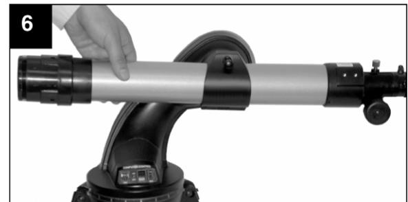
6. **Coloque y balancee el tubo óptico:** Coloque el tubo óptico en el anillo de soporte. Apriete el tornillo de aseguramiento mas no lo apriete. Deslice el tubo hacia delante y hacia atrás hasta que encuentre la posición donde en tubo permanezca horizontal (sin que se incline hacia algún lado por sí solo). Apriete el tornillo de aseguramiento firmemente.
