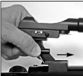
**Fig. 8a:** Deslice el buscador en la ranura.
