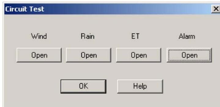
Presione el botón “Circuit Test” para poner al datalogger de irrigación en modo de prueba. En este modo, todas las demás funciones del datalogger se detienen. No presione este botón a menos que desee llevar a cabo una prueba porque esto puede interrumpir el comportamiento de su sistema de irrigación.
