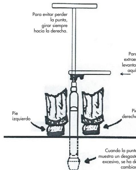
Hacer un giro rápido hacia la derecha solo para cortar la muestra. Extraer el tubo girando el extractor lentamente hacia la derecha. Siguiendo estas instrucciones dispondrá de una muestra perfecta y sacará el extractor del suelo sin romper el suelo o césped. Sacar la muestra de suelo a través de la sección cortada del tubo. Cuanto más húmedo es el suelo, con más cuidado debe seguir estas instrucciones.
