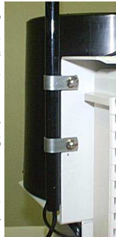
Anemómetro atornillado a la placa de la estación
