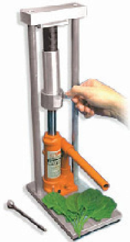
Consiga una recolección de muestras de savia con la **Prensa Hidráulica de Extracción de Savia WDDL-2720** que convierte un trabajo laborioso en un método rápido y fácil de usar.
