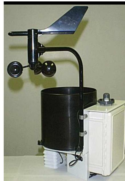
Excluyendo el anemómetro, la estación meteorológica WatchDog viene completamente armada y lista para montar. El brazo del anemómetro está sujeto a la placa trasera de la estación por dos abrazaderas. Después de colocar el brazo en posición, apriete los tornillos para asegurar el brazo en su posición.
