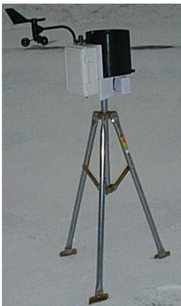
ajuste la altura. Apriete los tornillos de modo que el poste quede perpendicular al suelo. Finalmente, monte la estación en el poste con las abrazaderas en U.
