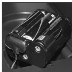
Fig. 11a: Instale las baterías
