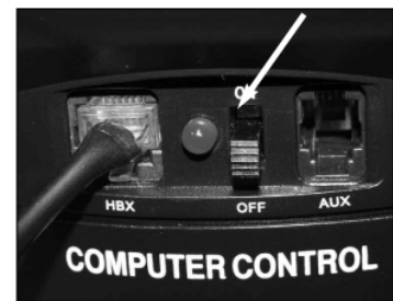
Fig. 11b: Conecte el controlador y encienda el panel de control.
