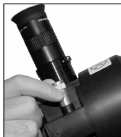
Fig. 10: Inserte el ocular y enfoque.
