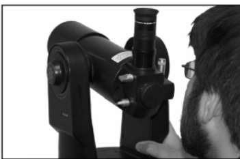
Fig. 13: Asómese por sobre el tubo óptico del telescopio.
