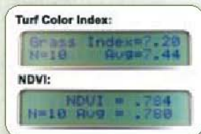
Muestra el Índice de Color del Césped y el NDVI en la pantalla LCD
