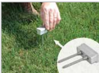
Piloto par Fabricacion de Agujeros para Medidores TDR
