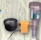
Transductor de Presión Se adapta a los tensiómetros "Irrrometer" y permite el uso del indicador de aguja para mediciones Artículo 3669
