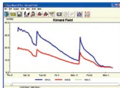
Specware Pro mostrando información de dos sensores WaterScout SM 100 a dos profundidades diferentes.
