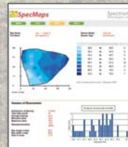
TDR 300 en un green: Las áreas con más humedad de suelo se muestran en azul más oscuro.
